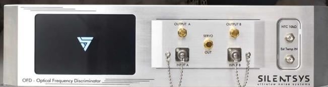
« Le discriminateur de fréquence optique (OFD), produit permettant de stabiliser en fréquence des sources laser »
