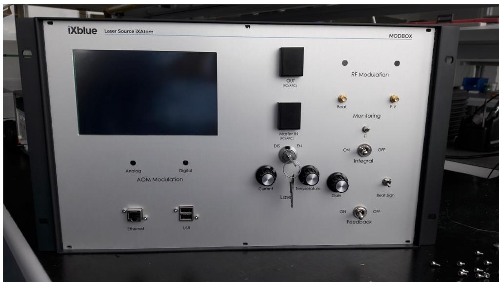
FIGURE 2 : Source laser pour l'interférométrie atomique comprenant le modulateur I&Q
