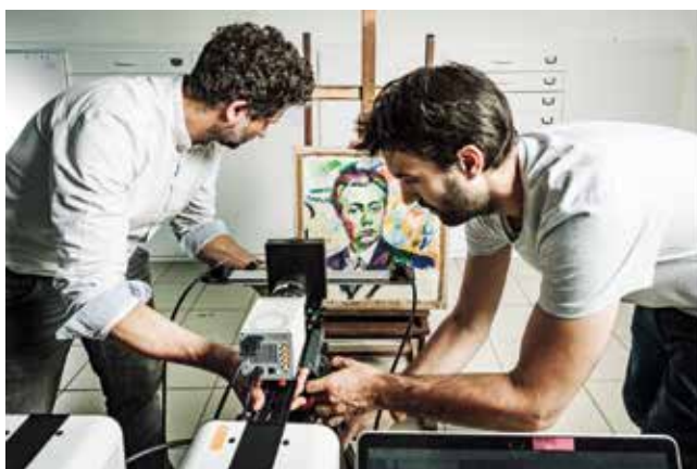
Figure 1. a : Système d'imagerie de luminescence positionné devant Autoportrait (1905) de Robert Delaunay, conservé au Centre Pompidou. © Cyril Fresillon / PPSM / IPANEMA / CNRS Images. b : collecte d'images de luminescence sous illumination centrée autour de 460 nm. © Cyril Fresillon / PPSM / IPANEMA / CNRS Images.
