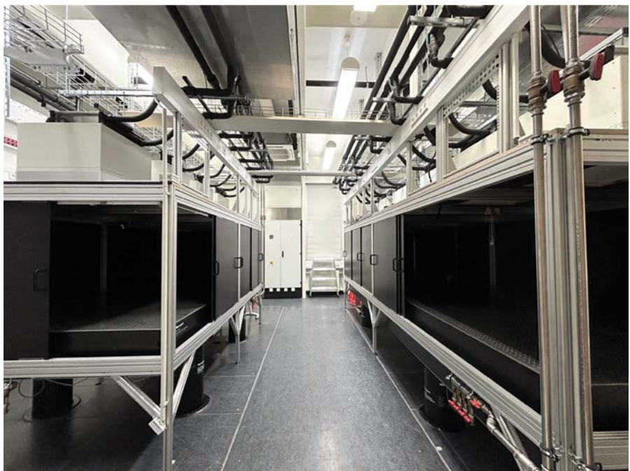
Figure 1. Nouveau laboratoire laser à l'Institut Max Planck d'Optique Quantique en Allemagne, équipé de tables optiques et d'un système de stabilisation de la température. ©MPQ/Aidelsburger.
