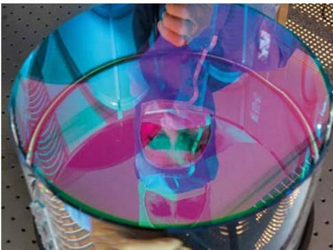
Les miroirs utilisés par les détecteurs d'ondes gravitationnelles Virgo et LIGO sont synthétisés par une technique de dépôt bien particulière : la pulvérisation par faisceaux d'ions. C'est la seule capable de réaliser des empilements de couches minces exempts de pertes optiques, tout en ayant une uniformité remarquable sur des grands diamètres. Ces propriétés sont également recherchées pour d'autres grands instruments, comme les spectrographes installés sur les grands télescopes terrestres.
