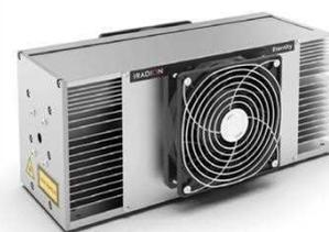
puissance est plus élevée. La série Eternity comprend désormais des lasers CO2 avec une puissance de 25, 30, 40 et 50 watts. La technologie laser brevetée d'Iradian repose sur un noyau en céramique, non réactif pour le mélange de gaz laser, et des électrodes métalliques qui excitent le gaz laser fixées à l'extérieur de la céramique pour prévenir fuite de gaz et contamination et donc améliorer la durée de vie.
