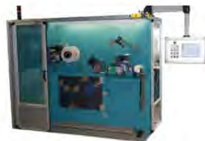
Les machines de bobinage peuvent inclure les fonctions de débobinage, de bobinage, de trancannage, de pré torsion, de contrôle de tension et de guipage. Les motifs de bobinage réalisable sont droits, croisés ou quadripolaire.
