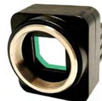
La CICADA se caractérise par sa haute résolution spatiale (1.3MP). Réalisée par hybridation d'un filtre mosaïque de type Bayer sur un capteur InGaAs du commerce (SONY IMX990), cette caméra légère (70 g) et très compacte (34×38×35 mm<sup>3</sup>) divise l'image en 9 bandes spectrales sur la plage SWIR (1100-1700 nm) afin d'en extraire le spectre en chaque point de l'image.
