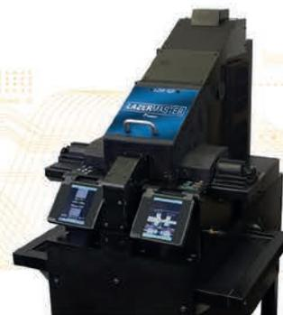
**Nouvelle plateforme de fusion par laser CO2 LQM125A+ Fujikura**
