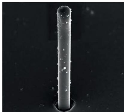
micro-explosion permet de faire translater un nano-pilier hors du matériau (illustration) voire de créer un nano-jet subissant les instabilités hydrodynamiques, qui se fige pour donner des structures à haut rapport de forme de morphologies variées. Leur diamètre est typiquement de 800 nm pour des hauteurs allant jusqu'à 15 µm.
