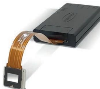
une résolution full HD (1920 x 1080 pixels). L'adressage peut être effectué à l'aide du logiciel générateur de motifs fourni, du logiciel SLM Slideshow Player ou d'un logiciel de visualisation d'images standard.
