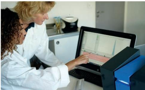
La technique de diffusion dynamique de la lumière, couramment désignée sous l'acronyme anglais DLS (Dynamic Light Scattering), s'est rapidement imposée au fil des décennies comme la méthode de mesure prédominante dans les laboratoires pour l'analyse de la taille et de la distribution des nanoparticules en suspension dans des liquides.
