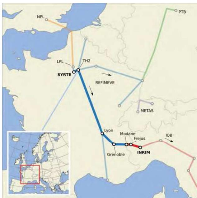
Schéma des liaisons par fibre optique permettant de transférer des signaux ultrastables de temps et de fréquence en France et dans les pays voisins. La liaison franco-italienne s'appuie sur l'infrastructure nationale de recherche REFIMEVE entre Paris et Modane.
