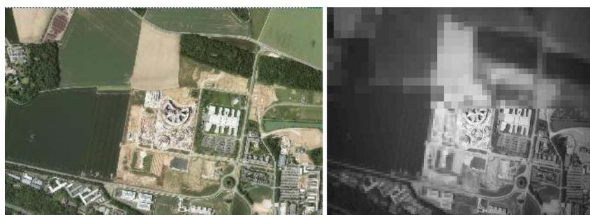
Fig. 2 : Image initiale et réponse simulée pour un capteur à 4 zones de résolutions différentes
