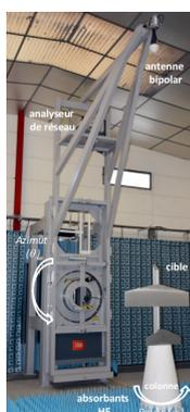
Fig. 1: Moyen expérimental sphérique RADAR 3D
