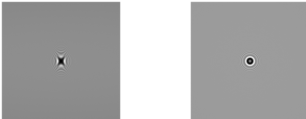
Figure 1. A gauche : exemple d'hologramme simulé d'objet sphérique dans une canalisation cylindrique en verre remplie d'eau. A droite même hologramme pour une cuve à parois planes et un faisceau d'illumination collimaté.
