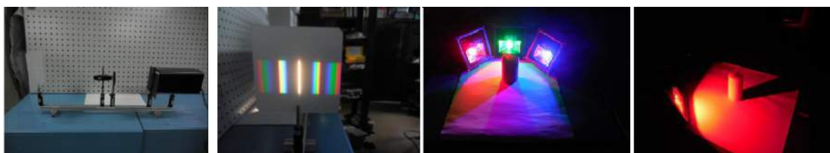
FIGURE 1 : de gauche à droite : a) montage d'un spectromètre à fente et prisme à vision directe (PVD), b) spectre obtenu en remplaçant le PVD par un réseau. c) 3 projecteurs à LED dont les ombres font apparaître les couleurs primaires et secondaires d) couleurs par réflexion.
