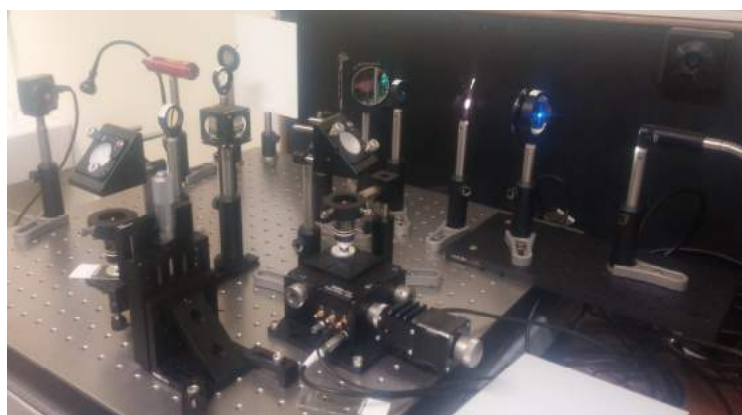
Fig. 1 : Dispositif d'imagerie OCT monté, aligné, caractérisé et exploité par les étudiants.
