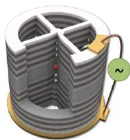
FIGURE 1 - Source semiconductrice de photons uniques : la boîte quantique est couplée à une cavité constituée de deux miroirs de Bragg, et la structure dopée p-i-n est connectée électriquement.
