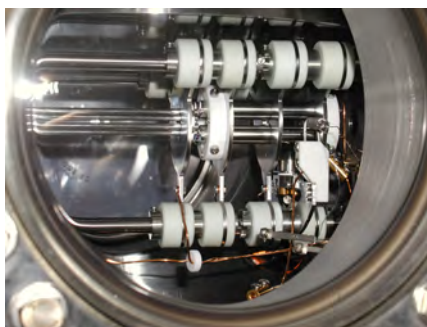
FIGURE 1 : Dispositif expérimental avec de droite à gauche un double quadrupole (4 barreaux et une électrode centrale qui délimite deux zones de piégeage) et un octupole (8 barreaux). La longueur d'un quadrupole est de 20 mm.
