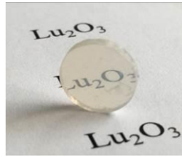
Fig.3 Pastille de Lu 2 O 3 frittée par SPS
