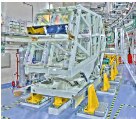
SCF LMJ dans l'atelier de maintenance rapprochée. Les 4 composants optiques vues de face sont des réseaux focalisants de 42x47cm<sup>2</sup> (© CEA/ E. Journot)
