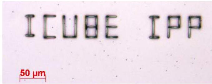
Figure 2 : Gravure sur silicium. Largeur de gravure de 2  $\mu\text{m}$ .
