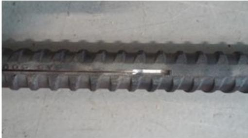
Géométrie de l'engravure pour installer la fibre optique
