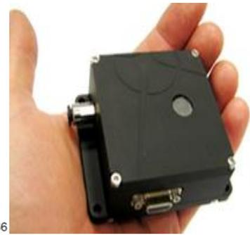
Fig 3: Composant laser VECSEL intégré
