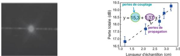
Figure 3 Image du mode fondamental pour  $\lambda=1.55\mu\text{m}$  (gauche) et ses pertes (droite).
