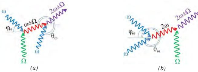
Fig. 1 : Principe des processus en cascade : (a) Type 1 (PC1) : diffraction acousto-optique linéaire par une OA stationnaire, suivie d'une génération de fréquence somme ; (b) Type 2 (PC2) : génération de second harmonique suivie d'une diffraction acousto-optique linéaire par une OA stationnaire.
