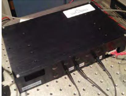
Fig. 2 : Séparateur de faisceau 1x2 à fibre polarisante
