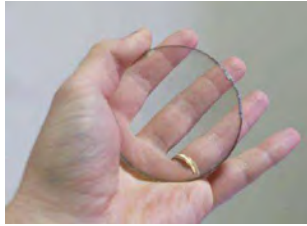
Figure 1 : hublot en céramique transparente de spinelle ( \varnothing 75 mm x ép 10 mm)
