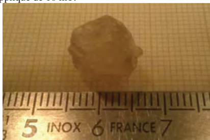
Fig. 1 : monocristal (~0.5 cm 3 ) de (Lu,Gd,Eu) 2 O 3 après croissance en solution
