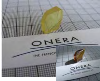
Figure 1 – Photo d'un monocristal d' \text{AgGaGeS}_4 recuit. En insert, se trouve un cristal brut de croissance issu du même lingot.
