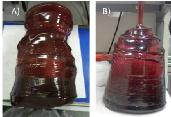
Figure 1 : lingots de saphir dopés titane obtenus par le procédé Kyrououlos. En A) lingot obtenu par un control manuel des paramètres de croissance, en B) un lingot obtenu avec notre control automatisé.
