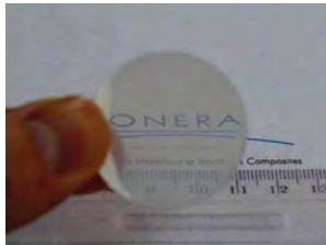
Figure 2 : hublot en céramique transparente d'alumine ( \varnothing 30 mm x ép 1 mm)
