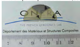
Figure 3 : échantillons en céramique transparente d'yttrine ( Y_2O_3 ) après différents traitements (ép 1 mm).
