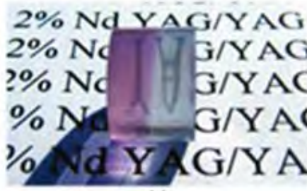
Figure 1 : Céramique transparente de YAG sous forme de bicouche élaborée par co-coulage de suspensions avec une zone dopée au néodyme (à gauche) et une seconde non dopée (à droite).
