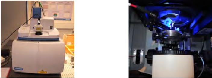
Fig. 1 : A gauche : nouveau prototype de micro-spectromètre. A droite : système d'éclairage permettant l'imagerie holographique.
