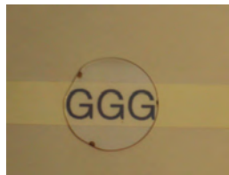
Fig. 2 : Production ESRF, 10 \mu m de GGG:Eu sur 500 \mu m GGG non dopé, 1" diamètre
