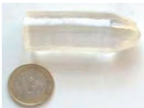
Fig.1 : Monocristal de 2% \text{Yb}^{3+} : \text{CaGdAlO}_4 synthétisé par méthode Czochralski.
