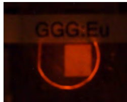
Fig. 3 : Image de la lumière visible émise par un GGG:Eu sous irradiation d'un générateur X de laboratoire (40kV,40mA). Image prise avec un appareil photo numérique.
