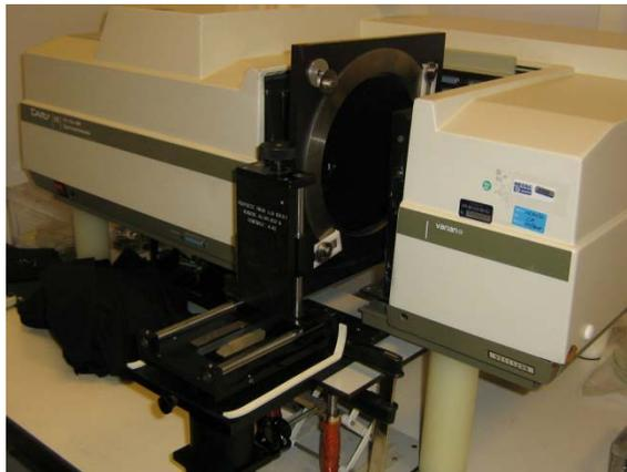
Spectrophotomètre + Outillage de positionnement
