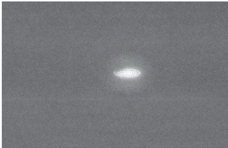
FIGURE 1 : Cristal de Coulomb bi-dimensionnel contenant environ 40 ions de  $\text{Sr}^+$  refroidis par laser. Le piégeage est obtenu par un système d'électrodes en cuivre doré déposé sur un substrat plan. La largeur des électrodes dans le plan du substrat est de 400  $\mu\text{m}$  environ.
