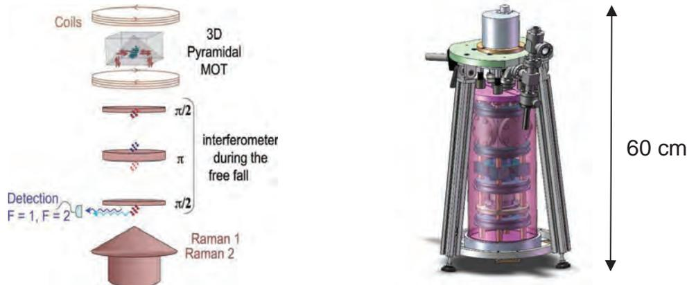
**FIG. 1. a)** (gauche) Schéma de principe du gravimètre compact. Les atomes sont piégés dans la pyramide avant de tomber sous l'effet de la gravité. L'interféromètre est alors réalisé à l'aide des faisceaux montant et descendant, rétro-réfléchi par la pyramide. **b)** (droite) Image 3D de la tête de senseur en construction.
