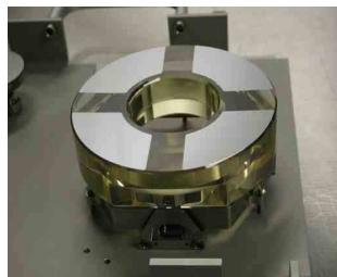
Mirror primaire Ø105 mm pour télescope EUVI de la mission STEREO. Mo/Si multicouches (4 quadrants):  $\lambda = 17.1, 19.5, 28.4$  et 30.4 nm
